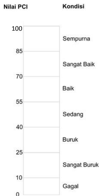
**Gambar 3.3 Hubungan Nilai  $PCI$  dan Kondisi**
