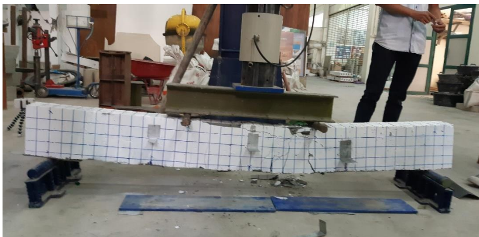
Gambar 5.20 Benda Uji BNM20 Tampak Depan Setelah Dibebani
