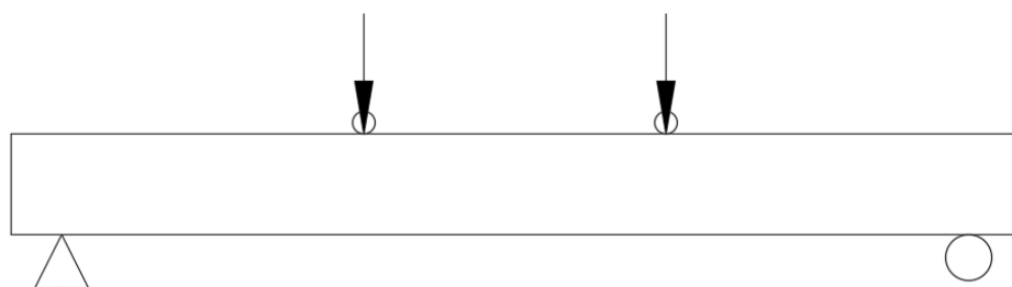
Gambar 3.6 Model Pembebanan Balok Dengan Sistem Dua Titik
