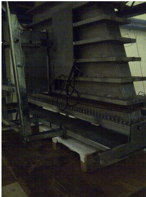
Gambar 6. Bagian Radiasi Elektron dari MBE
