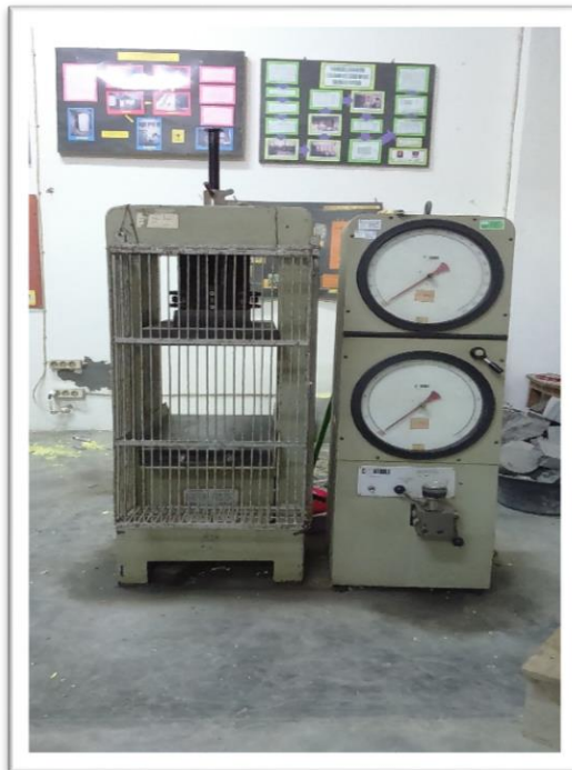
Alat Uji Kuat Tekan Dan Tarik Beton
