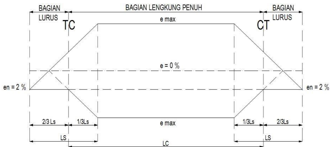
Gambar 3.7. Superelevasi pada Tikungan Jenis Full Circle (FC) (Sumber : Hendarsin, 2000)
