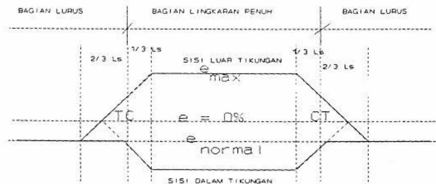
**Gambar 3.4 Metoda Pencapaian Superelevasi pada Tikungan Tipe FC**
