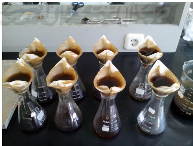
Penyaringan Serat yang di Ekstrak menggunakan NaOH
