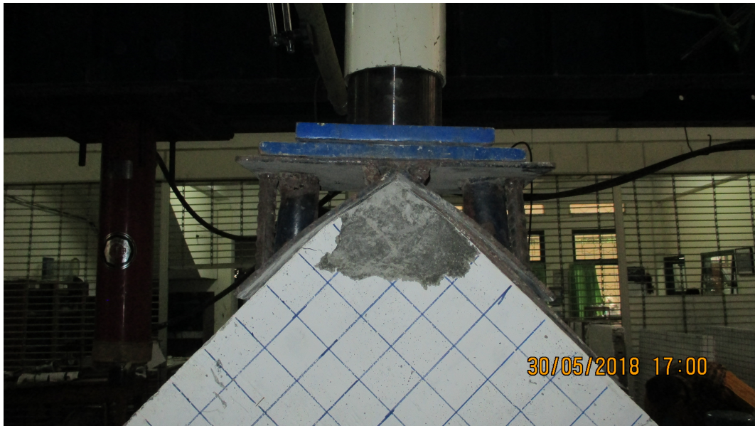
Lampiran L-1. 19 Kegagalan pada tumpuan bagian atas (Sepatu uji geser)
