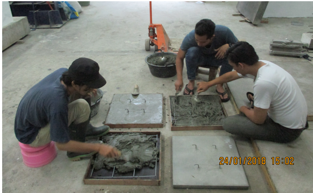
Lampiran L-1. 5 Proses pengecoran lapisan kulit ( skin ) panel dinding benda uji tipikal 1 (Uji tekan)
