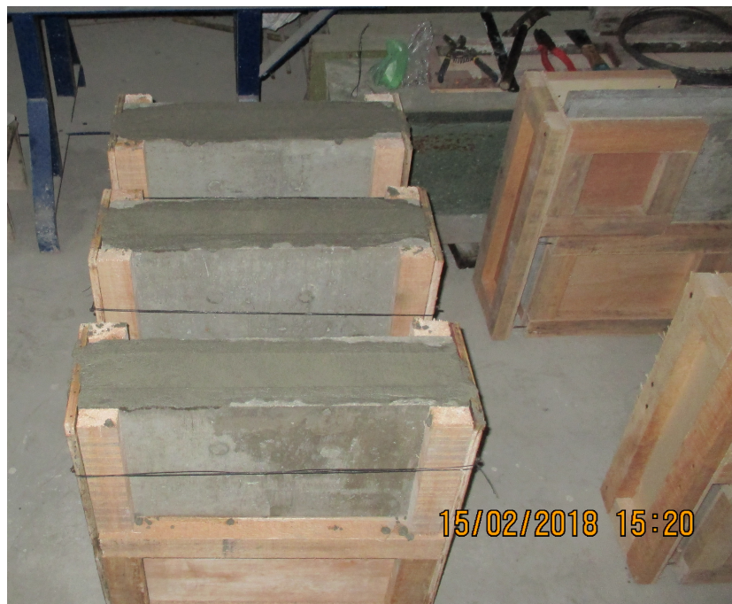
Lampiran L-1. 12 Hasil pengecoran lapisan inti ( core ) panel dinding benda uji tipikal 1 (Uji tekan)
