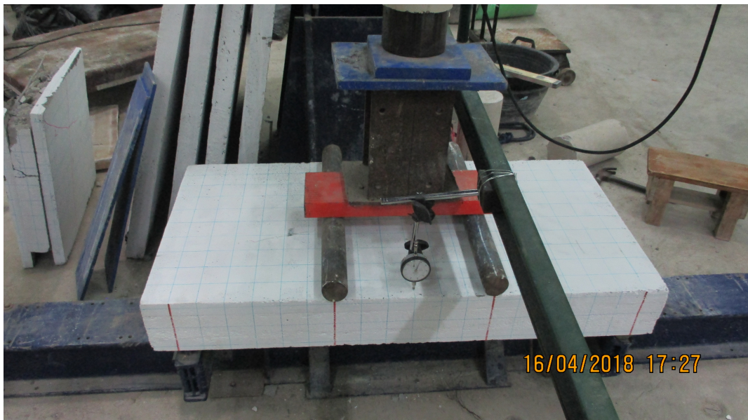
Lampiran L-1. 14 Proses pengujian lentur panel dinding tipikal 2
