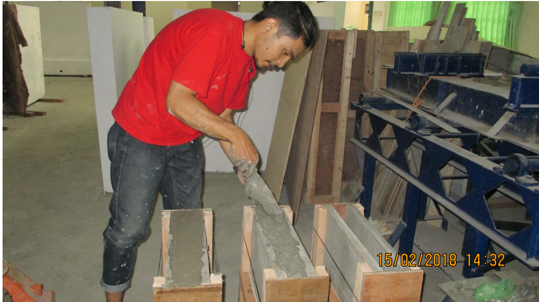
Lampiran L-1. 11 Proses pengecoran lapisan inti ( core ) panel dinding benda uji tipikal 1 (Uji tekan)
