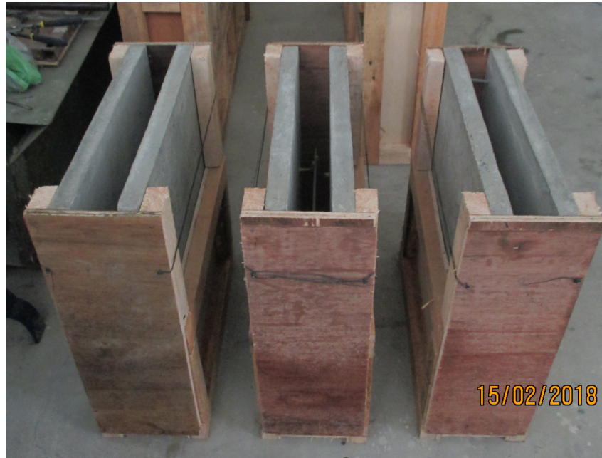
Gambar 4.17 Lapisan kulit ( skin ) panel dinding pada cetakan lapisan inti ( core )
