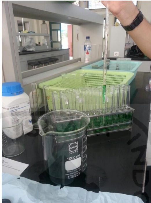
Gambar B.5 Proses Memasukan Larutan BGLB kedalam tabung di Laboratorium Kualitas Air Teknik Lingkungan Universitas Islam Indonesia
