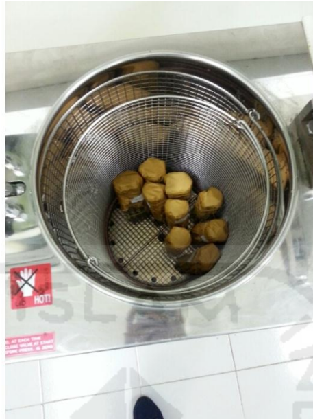
Gambar B.3 Proses Mensterilkan Larutan Lactose broth di Laboratorium Kualitas Air Teknik Lingkungan Universitas Islam Indonesia
