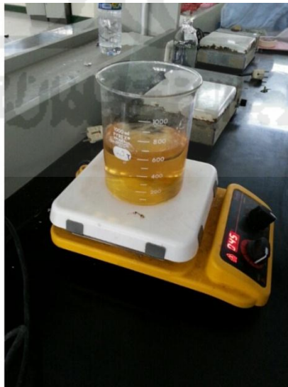
Gambar B.2 Proses Pembuatan Larutan Lactose broth di Laboratorium Kualitas Air Teknik Lingkungan Universitas Islam Indonesia
