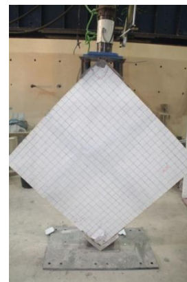
Gambar 13 Hasil Retakan pada Benda Uji Geser Diagonal
