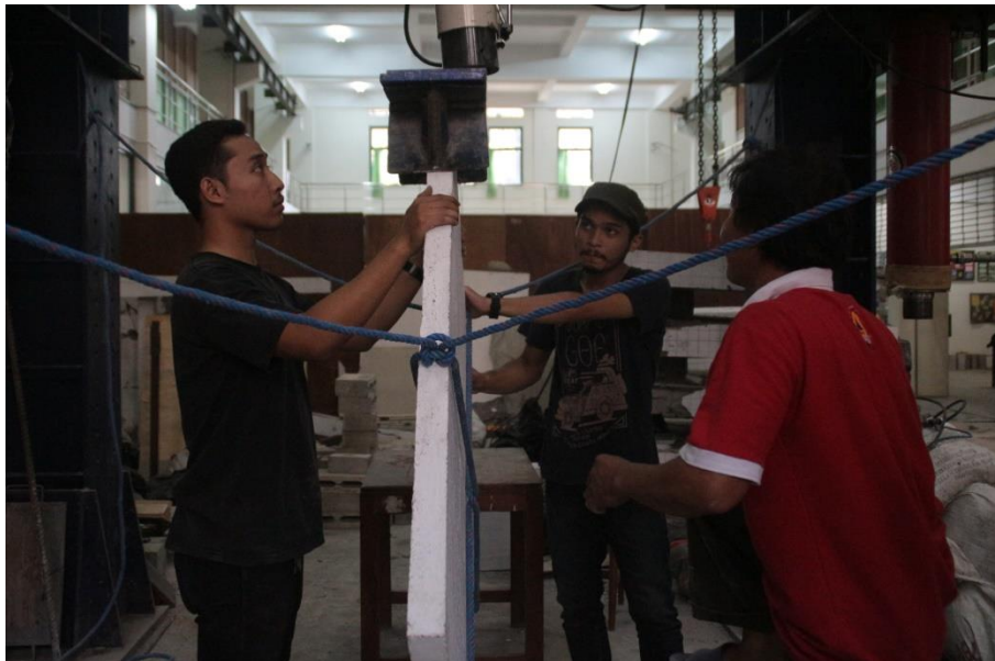
Gambar L-3.2 Proses Setting Alat pada Pengujian Geser Diagonal
