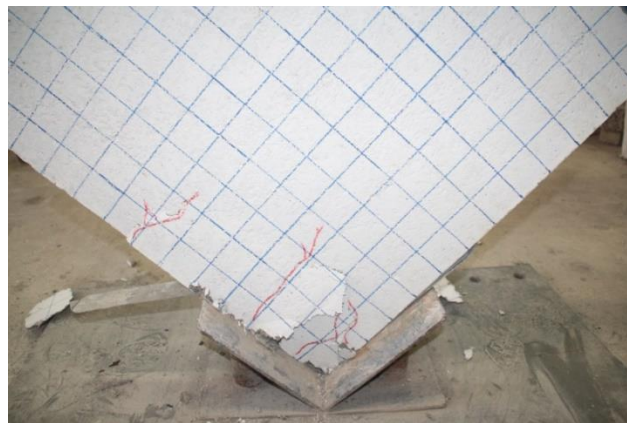
Gambar 5.28 Retak pada Bagian Bawah Sampel Uji Geser Diagonal
