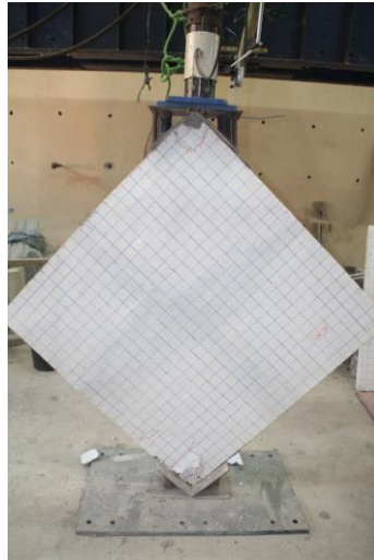
Gambar 5.27 Hasil Retakan pada Benda Uji Geser Diagonal
