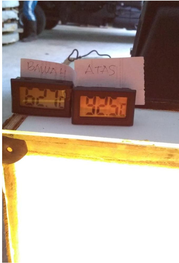
proses pembacaan suhu pada thermomet digital dari kedua sisi permukaan benda uji genteng komposit
