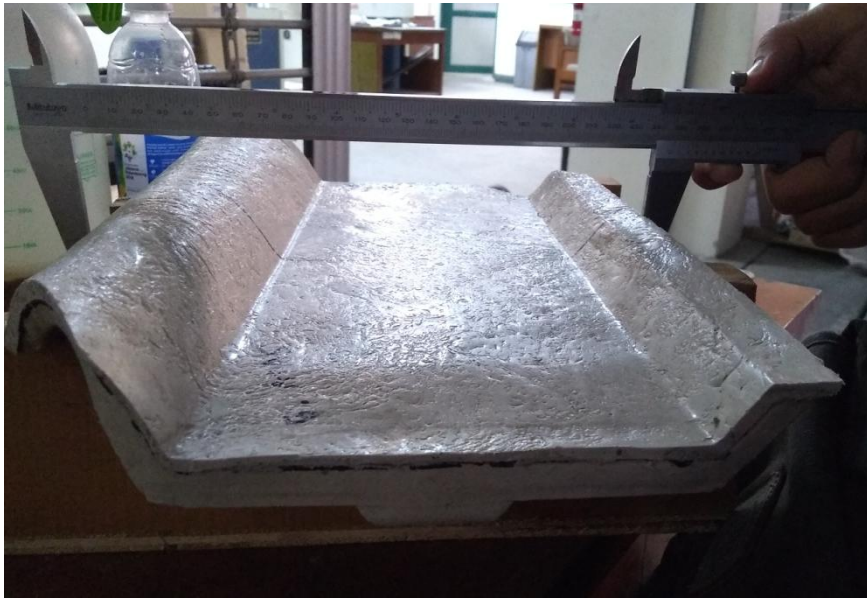
Proses pengujian analisis ukuran pada benda uji genteng komposit
