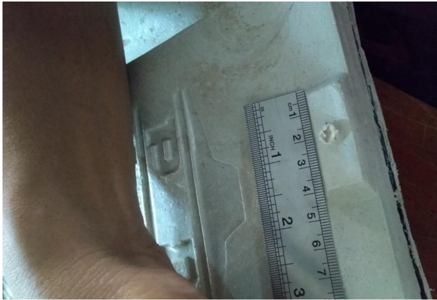
Proses pengujian ukuran pengait benda uji genteng komposit
