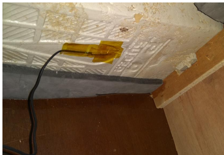
Tampah bagian bawah permukaan benda uji genteng komposit pada saat proses pengujian penyerapan panas
