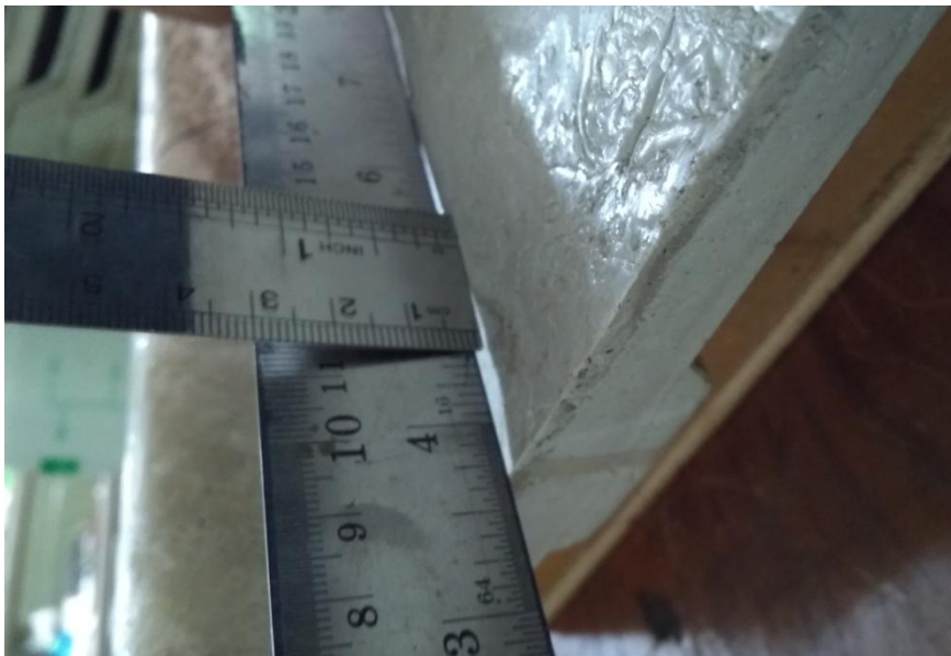
Proses pengujian analisis kerataan (pengukuran celah) pada benda uji genteng komposit
