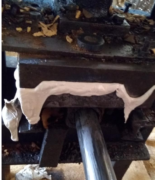
Proses mencetak genteng komposit dengan alat press manual
