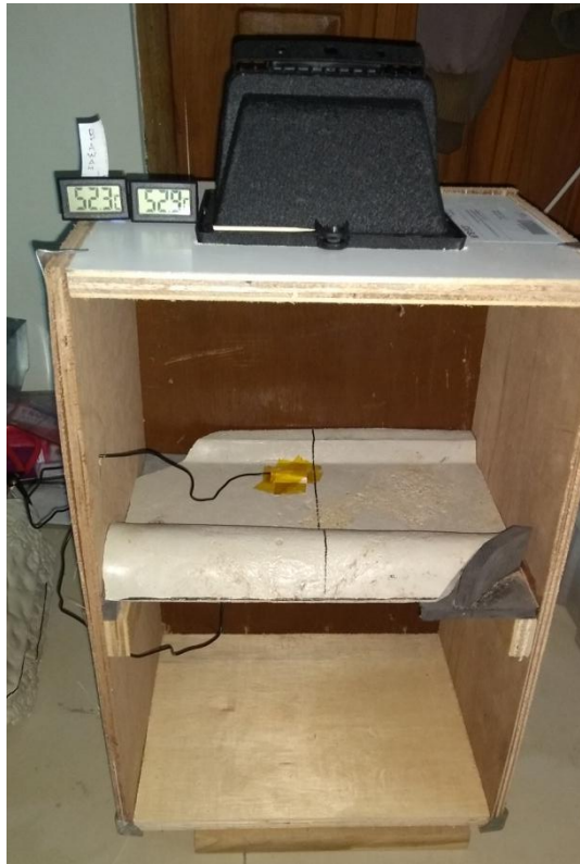
Proses persiapan dan peletaan benda uji kedalam box untuk pengujian penyerapan panas
