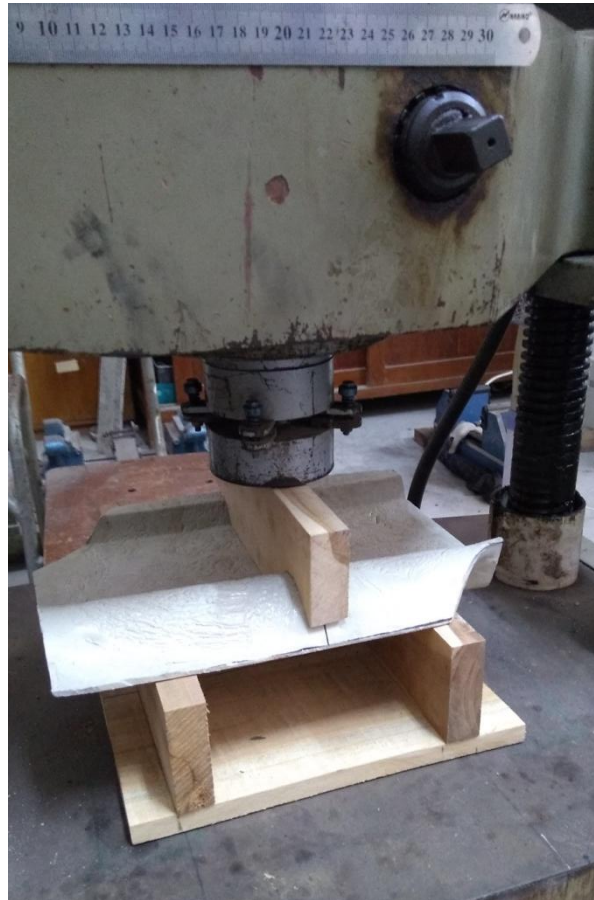
Proses pengujian beban lentur pada benda uji genteng komposit
