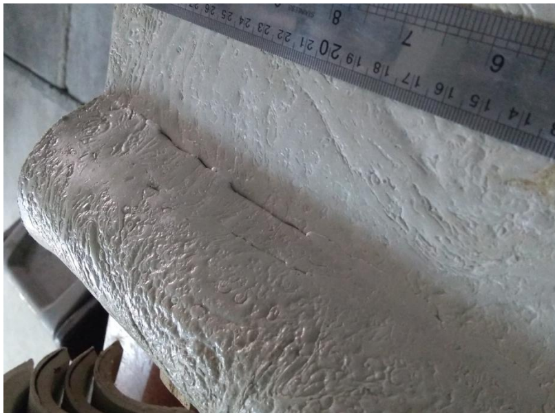
proses pengujian sifat tampak benda uji genteng komposit
