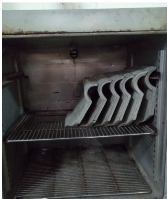
Proses oven untuk mencari berat kering benda uji genteng komposit
