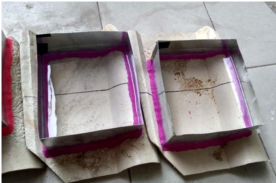
Proses pengujian rembesan air pada benda uji genteng komposit
