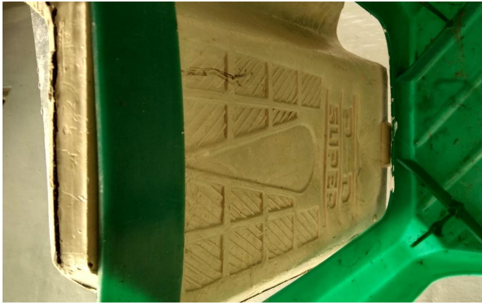
proses pengamatan pengujian rembesan pada bagian bawah benda uji genteng komposit
