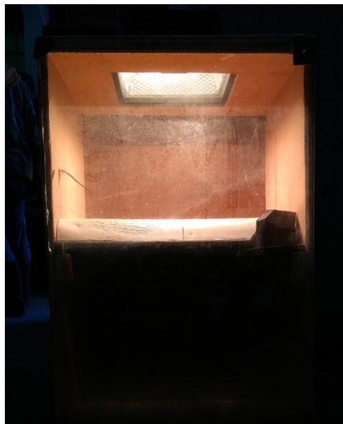
Proses pengujian penyerapan panas pada benda uji genteng komposit
