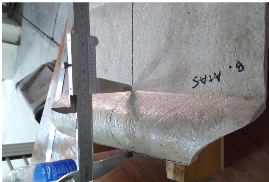
Proses pengujian analisis ukuran pada bagian penopang genteng
