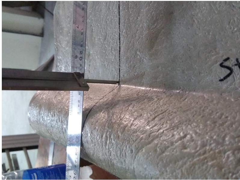
Proses pengujian analisis ukuran pada penopang genteng komposit
