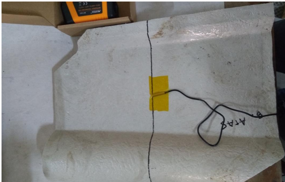
Proses pemasangan sensor suhu thermometer digital pada permukaan bagian atas benda uji genteng komposit
