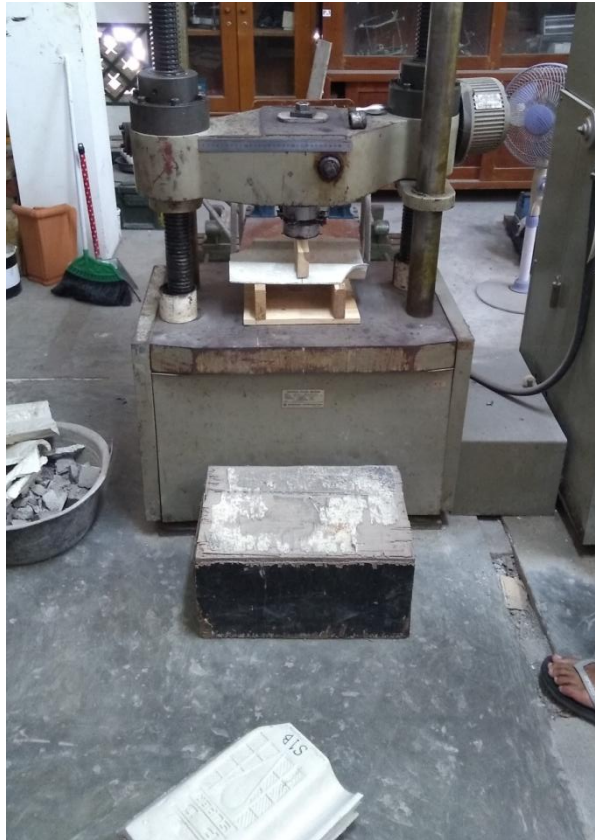
Proses pengujian beban lentur pada benda uji genteng dengan menggunakan alat UTM
