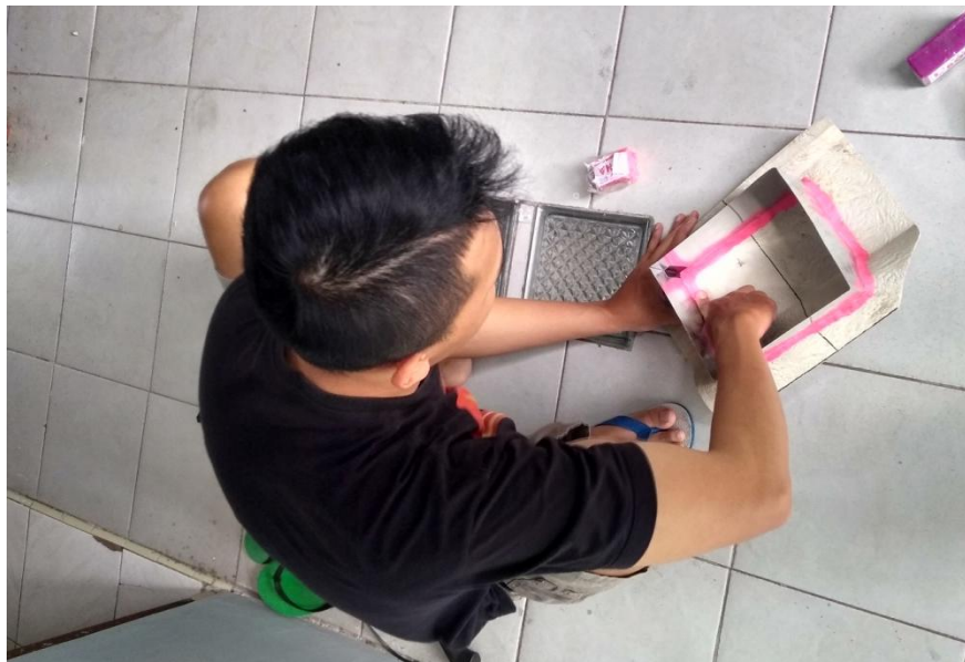
Proses pemasangan seng pada benda uji untuk proses pengujian rembesan
