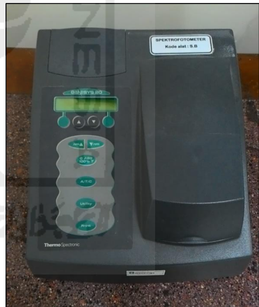
Gambar 4. Spektrofotometer tipe Genesys 20 Merk Thermo Spectronic
