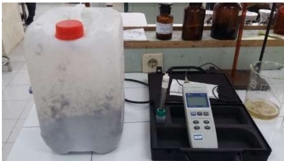
Gambar 9. Pengujian pH setiap 3 hari
