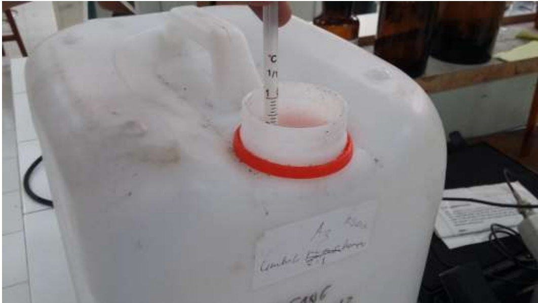
Gambar 10. Pengukuran suhu setiap 3 hari
