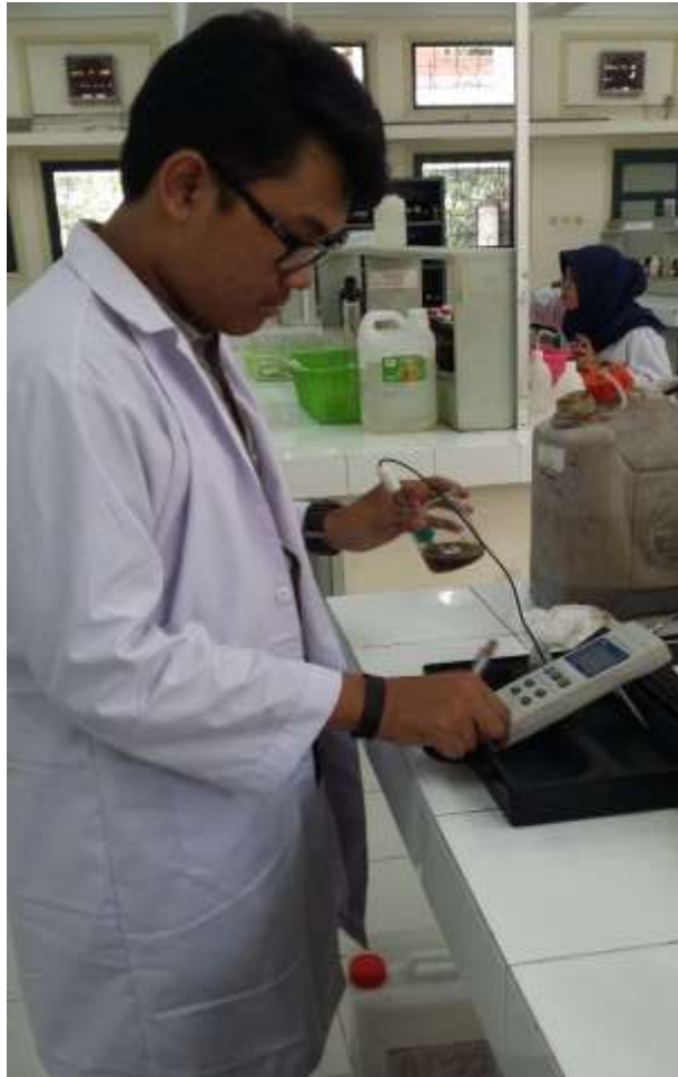
Gambar 8. Pengujian pH setiap 3 hari
