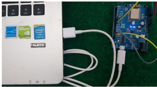
Gambar Kesalahan! Tidak ada teks dari gaya yang ditentukan dalam dokumen. 7: Koneksi Arduino dengan Komputer
