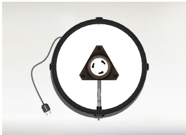
Gambar 4.8 Tampilan kerangka tabung mesin peniris tampak atas
