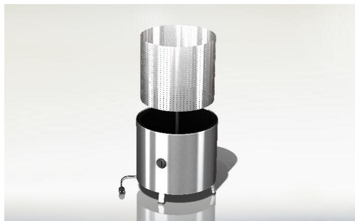
Gambar 4.5 Tampilan kerangka mesin tertutup dengan keranjang peniris
