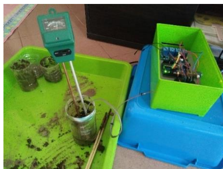
Gambar 4.3 Kalibrasi YL-100 (kelembapan tanah)
