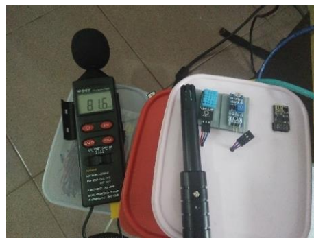
Gambar 4.2 Kalibrasi DHT11 (kelembapan udara)
