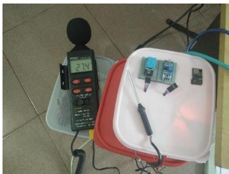
Gambar 4.1 Kalibrasi DHT11 (suhu)
