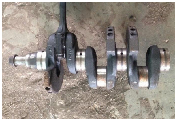
Gambar 4.5 Hasil Pembuatan Crankshaft
