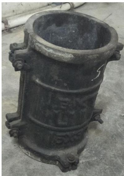
**Gambar L-1.6 Cetakan Silinder Beton**
