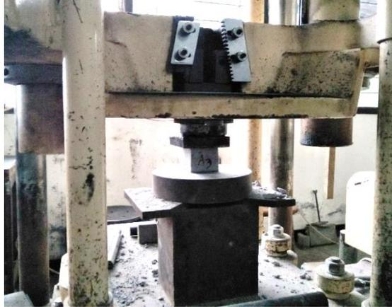
**Gambar L-5.1 Pengujian Kuat Tekan *Paving Block***
