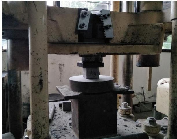
**Gambar 5.2 Pengujian Kuat Tekan *Paving Block***
