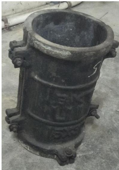
**Gambar 4.7 Cetakan Silinder Beton**
