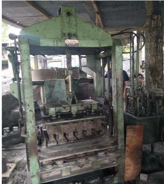
**Gambar 4.8 Mesin Cetak *Paving Block***
