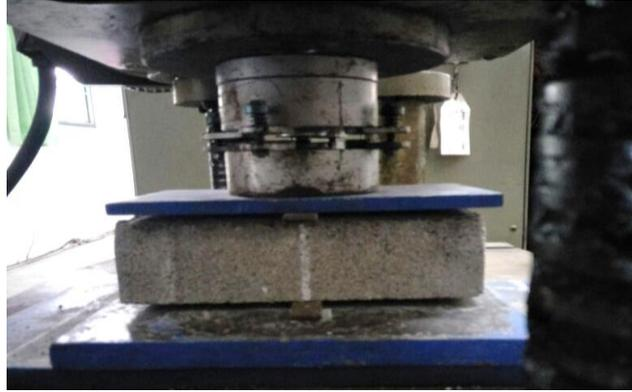
**Gambar L-5.4 Pengujian Kuat Tarik Belah *Paving Block***
