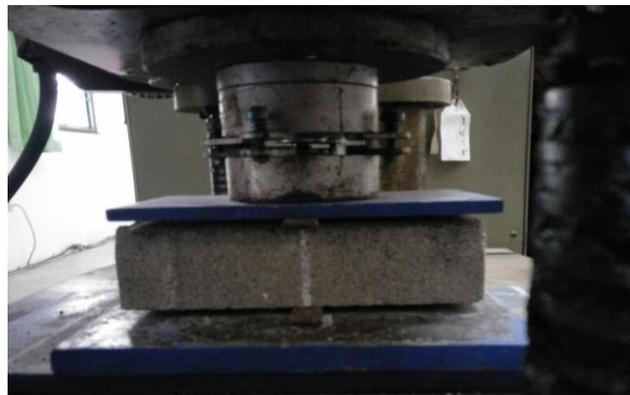
**Gambar 5.7 Pengujian Kuat Tarik Belah *Paving Block***
