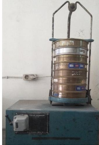
**Gambar L-3.1 Pengujian Analisis Saringan/Modulus Halus Butir (MHB)
