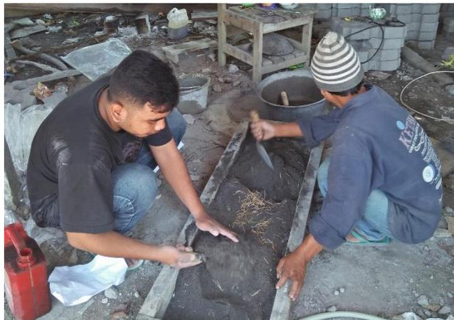
**Gambar 4.20 Proses Pencampuran Bahan Penyusun *Paving Block***
