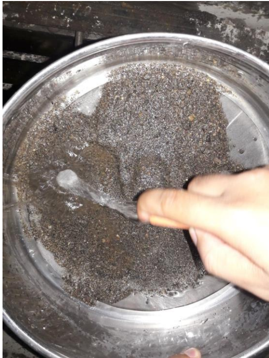
Gambar L-3.3 Pengujian Lolos Saringan No. 200 (Kandungan Lumpur) Agregat Halus
