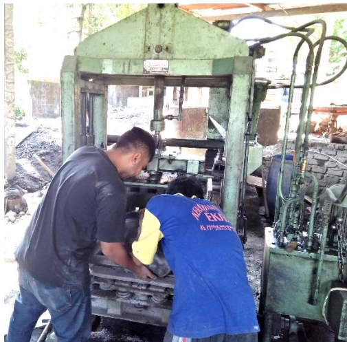
Gambar L-4.2 Proses Pencetakan Paving Block
