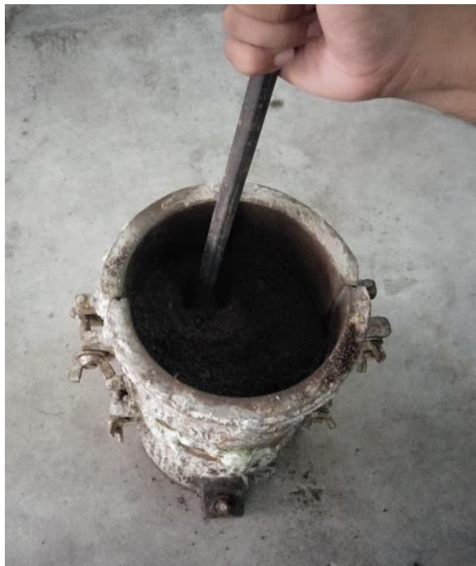
Gambar L-3.2 Pengujian Berat Volume Gembur Dan Berat Volume Padat Agregat Halus
