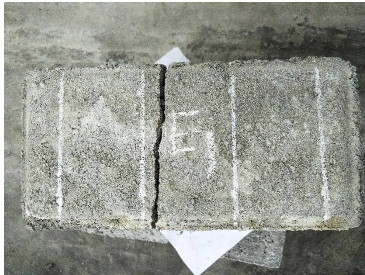
Gambar L-7.2 Pola Kerusakan Paving Block Akibat Beban Tarik Belah
