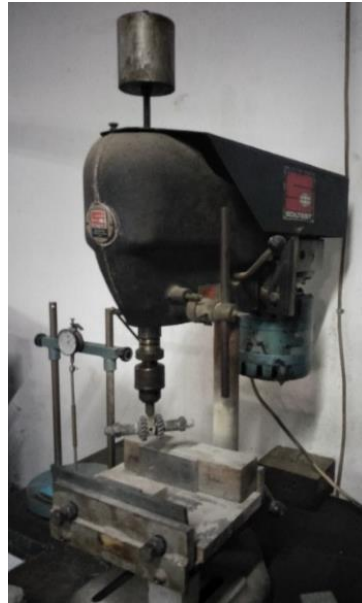
Gambar L-1.11 Mesin Uji Keausan Soiltest, INC
