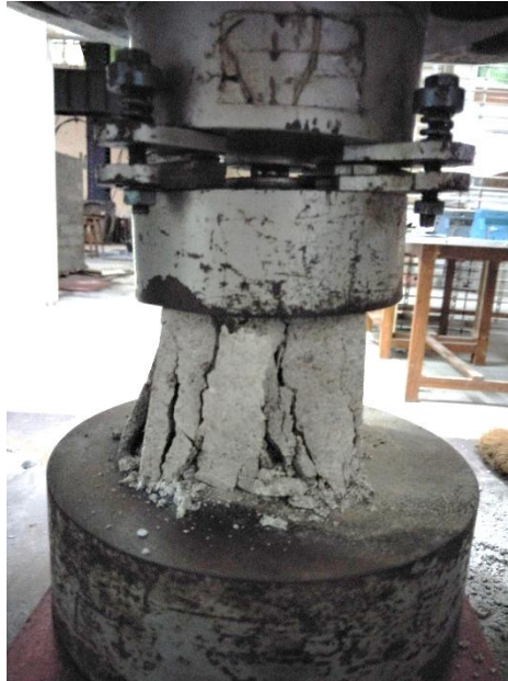
Gambar L-7.1 Pola Kerusakan Paving Block Akibat Beban Tekan
