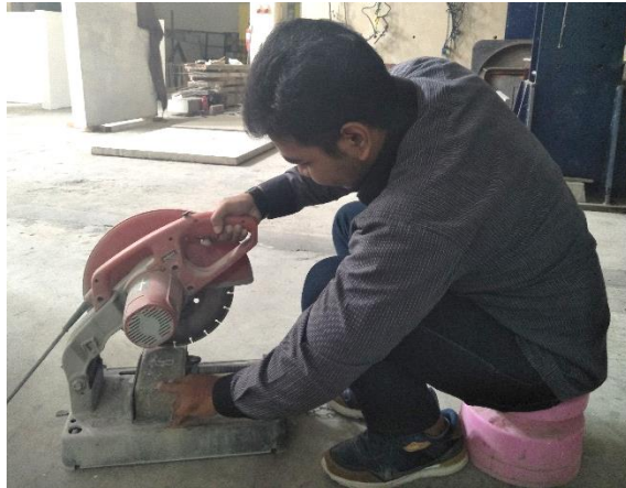
Gambar L-4.4 Proses Pemotongan Paving Block
