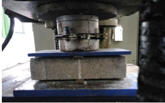
Gambar L-5.4 Pengujian Kuat Tarik Belah Paving Block
