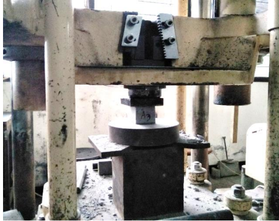
Gambar L-5.1 Pengujian Kuat Tekan Paving Block
