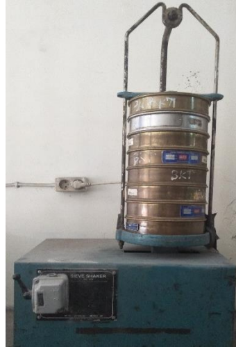
Gambar L-3.1 Pengujian Analisis Saringan/Modulus Halus Butir (MHB) Agregat Halus
