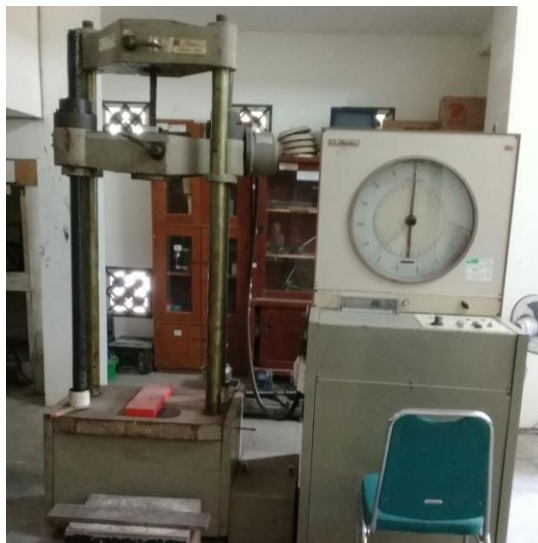
Gambar L-1.10 Mesin Uji Kuat Tarik Belah Universal Testing Machine ( UTM )
