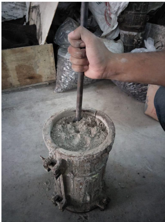
Gambar L-3.4 Pengujian Berat Volume Gembur Dan Berat Volume Padat Semen
