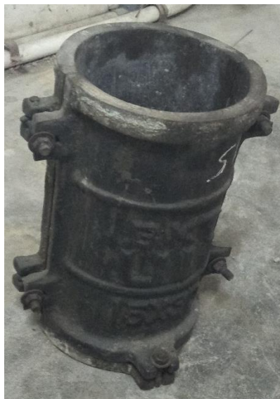
Gambar L-1.6 Cetakan Silinder Beton
