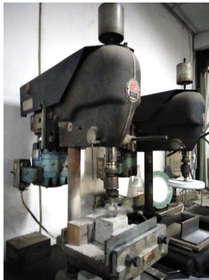
Gambar L-5.2 Pengujian Keausan Paving Block
