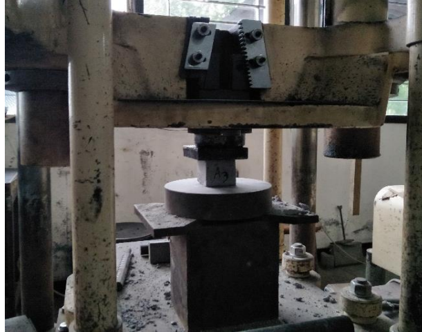
Gambar 5.2 Pengujian Kuat Tekan Paving Block
