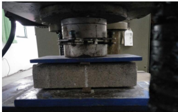
Gambar 5.7 Pengujian Kuat Tarik Belah Paving Block
