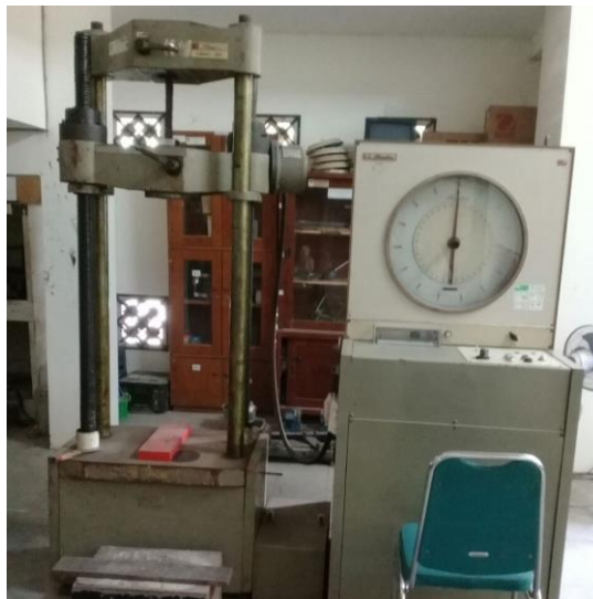
Gambar 4.11 Mesin Uji Kuat Tarik Belah Universal Testing Machine (UTM)
