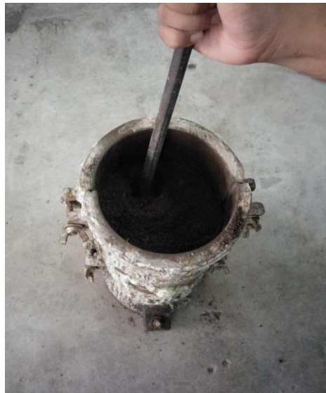
Gambar 4.17 Pengujian Berat Volume Gembur Dan Berat Volume Padat Agregat Halus
