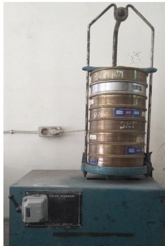
Gambar 4.16 Pengujian Analisis Saringan/Modulus Halus Butir (MHB) Agregat Halus
