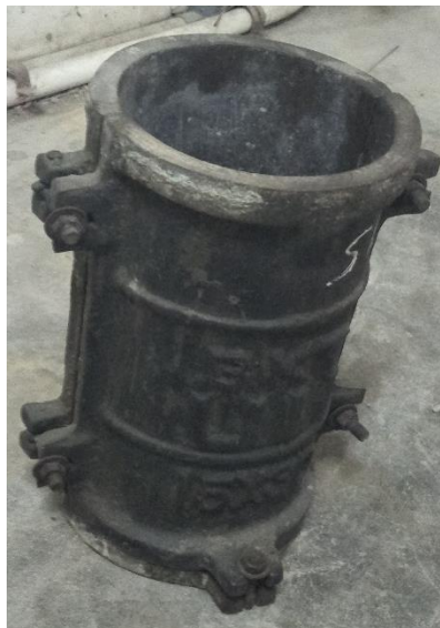
Gambar 4.7 Cetakan Silinder Beton
