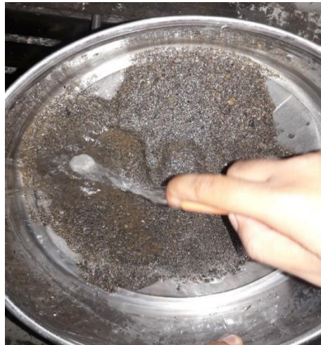
Gambar 4.18 Pengujian Lolos Saringan No. 200 (Kandungan Lumpur) Agregat Halus
