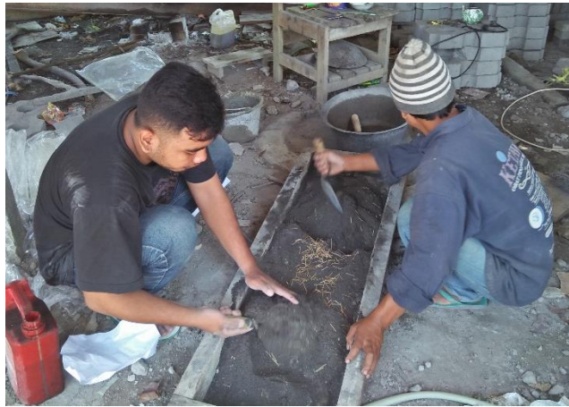
Gambar 4.20 Proses Pencampuran Bahan Penyusun Paving Block
