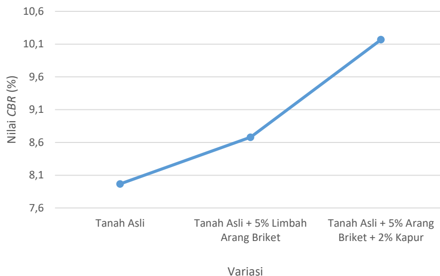
Gambar 5.23 Grafik Pengaruh Variasi Sampel Terhadap Nilai CBR Soaked
