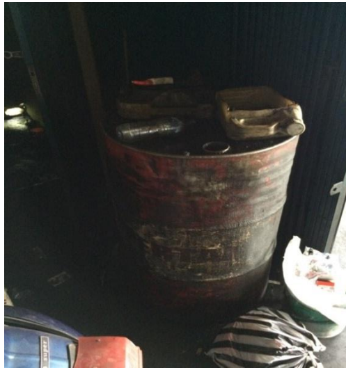
Gambar 4.8 Kemasan limbah pelumas dari bengkel perusahaan Z dengan kondisi berkarat tetapi tidak bocor.
