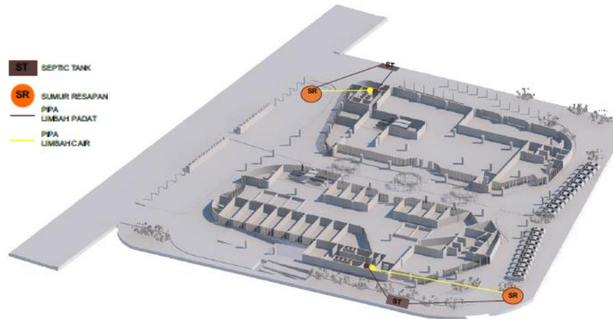
Gambar 4.17 Skema Sistem Sanitasi Bangunan
