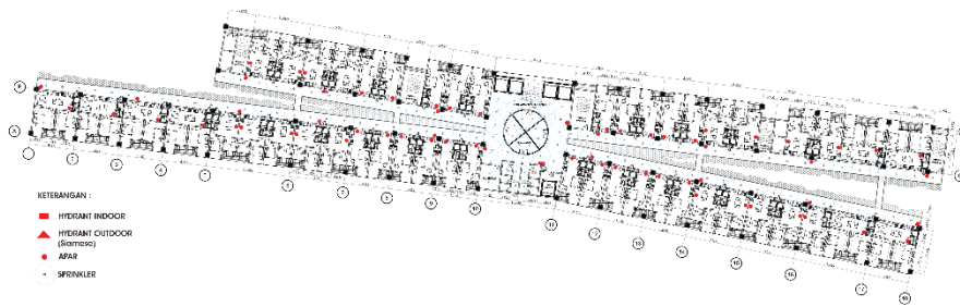
Gambar 4.24 Rencana Penanggulangan Kebakaran Lantai Tipikal 1-3, 5-7, 9-11, 13-15.
