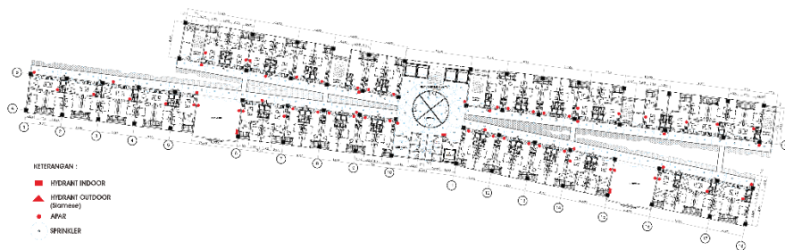
Gambar 4.25 Rencana Penanggulangan Kebakaran Lantai Tipikal 4,8,12.
