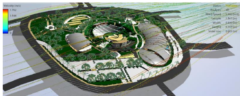
Gambar 5 40 Simulasi Autodesk Flowdesign dari Tampak Perspektif Kawasan Rancangan. Angin berasal dari arah Timur – Barat
