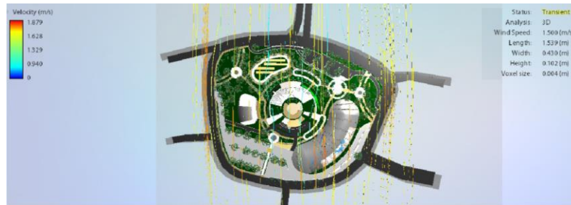
Gambar 5 51 Simulasi Autodesk Flowdesign dari Tampak Atas Kawasan Rancangan.
