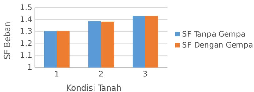
**Gambar 5.68 Kurva Nilai *Safety Factor* pada Timbunan 5 meter Saat Konstruksi**
