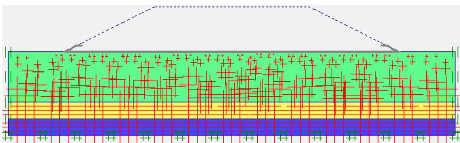
**Gambar 5. 64 *Initial Soil Stresses* Timbunan Lereng Tanah Asli 8m dengan Perkuatan Masa Konstruksi**
