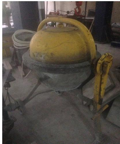
**Gambar 4.1 Mesin pengaduk beton**
