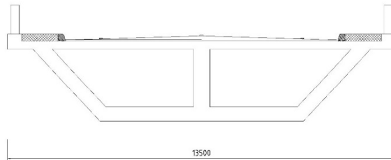
Gambar 4. 1 Jembatan Tipe Single Twin Cellular Box Girer yang akan di desain
