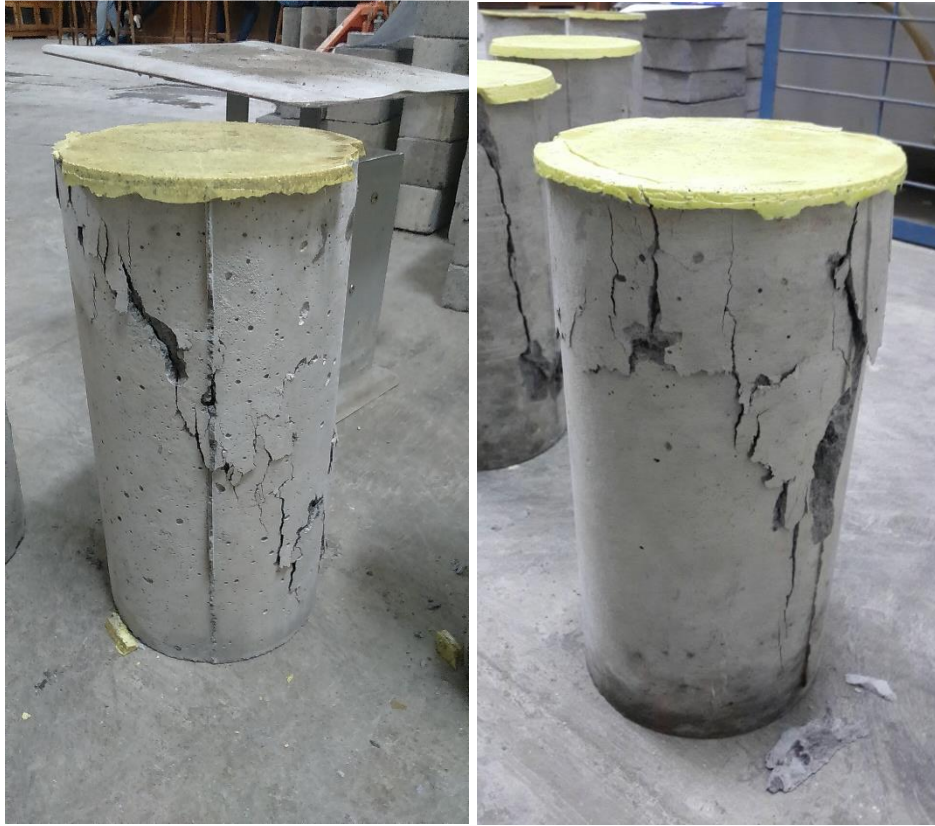
Gambar L-18.11 Pola Keretakan Benda Uji
