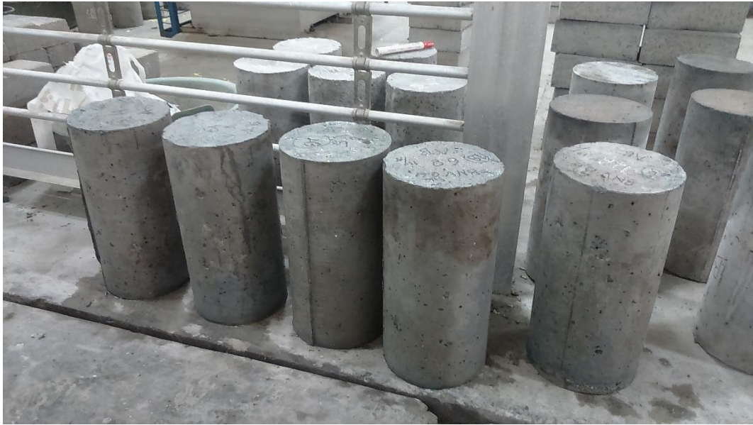
Gambar L-18.7 Benda Uji Setelah Perendaman
