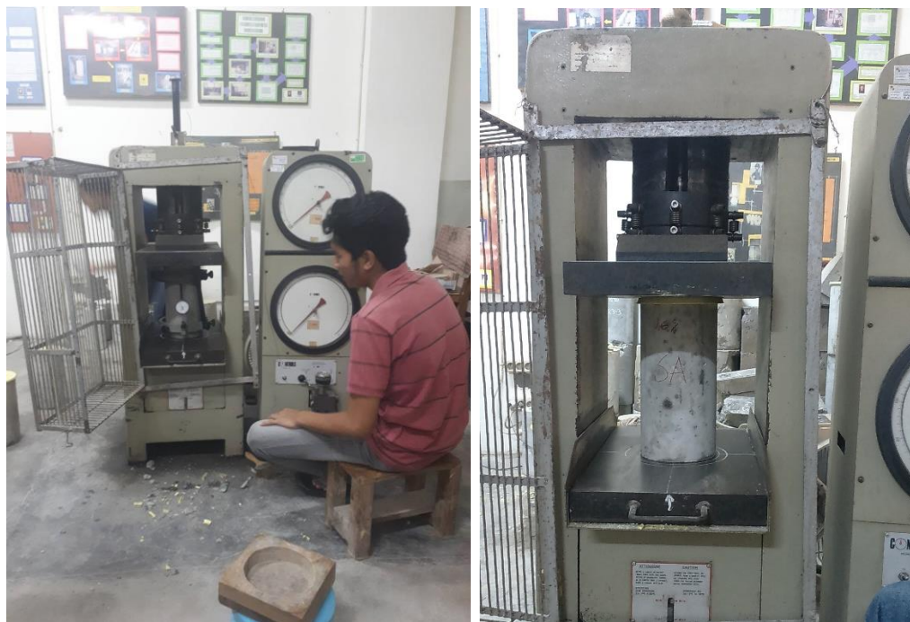
Gambar L-18.10 Pengujian Kuat Tekan dan Modulus Elastisitas Beton
