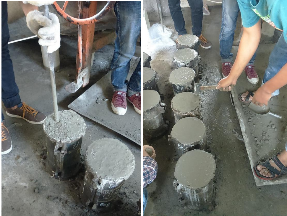
Gambar L-18.3 Pematatan Campuran Beton pada Cetakan Silinder
