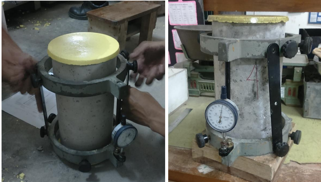
Gambar L-18.9 Pemasangan Benda Uji Silinder dan Dial Gauge
