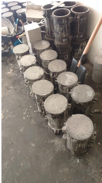
Gambar L-18.4 Benda Uji pada Cetakan Silinder
