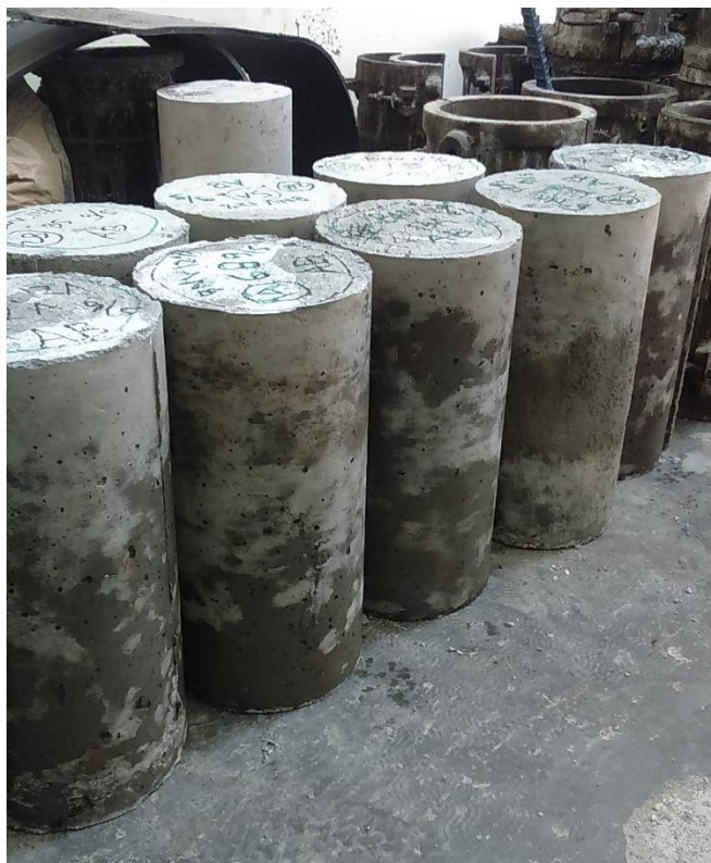
Gambar L-18.5 Benda Uji Setelah Dilepas dari Cetakan
