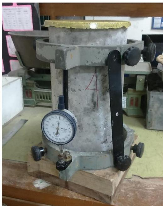
**Gambar 4.19 Kompresometer dengan *Dial Gauge***
