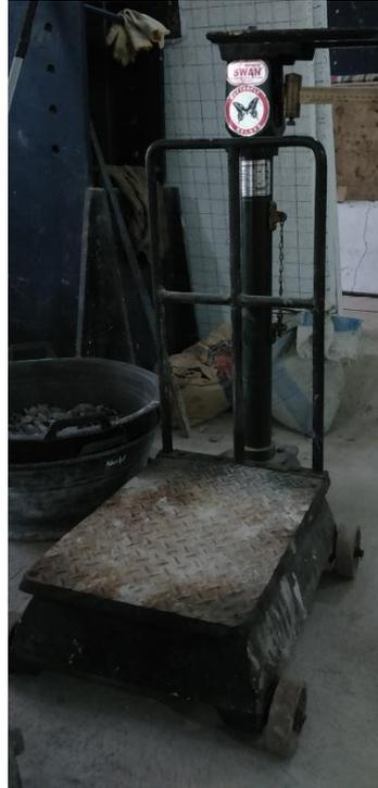
**Gambar 4.15 Timbangan Duduk (Kapasitas 150 kg)**
