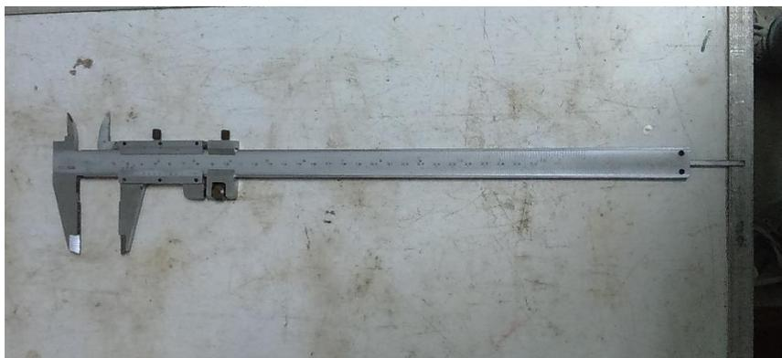
**Gambar 4.18** Kaliper atau Jangka Sorong
