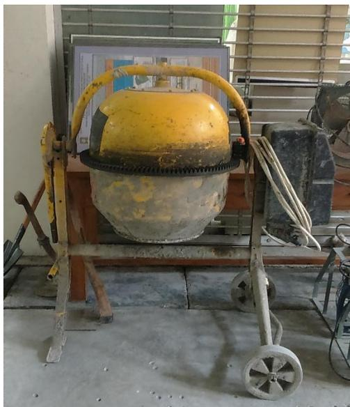
**Gambar 4.13 Mesin Pengaduk Beton/Molen**
