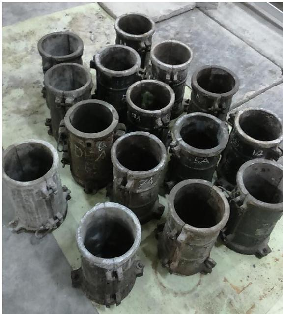
**Gambar 4.8 Cetakan Silinder**
