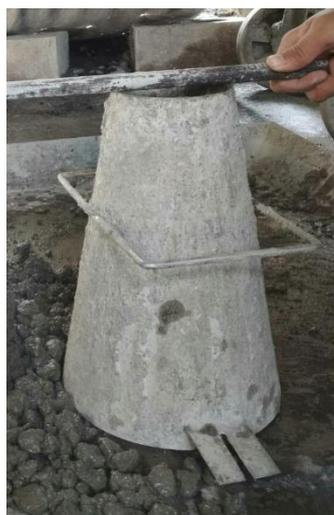
**Gambar 4.12 Kerucut *Abrams***
