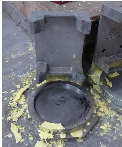
**Gambar 4.17** Cetakan *Capping*
