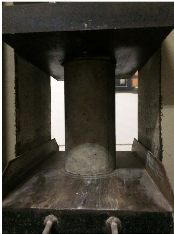
Gambar L3.4 Proses pengujian kuat tekan beton
