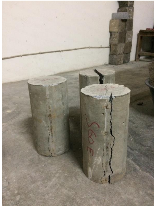
Gambar L3.2 Silinder beton setelah uji tarik belah
