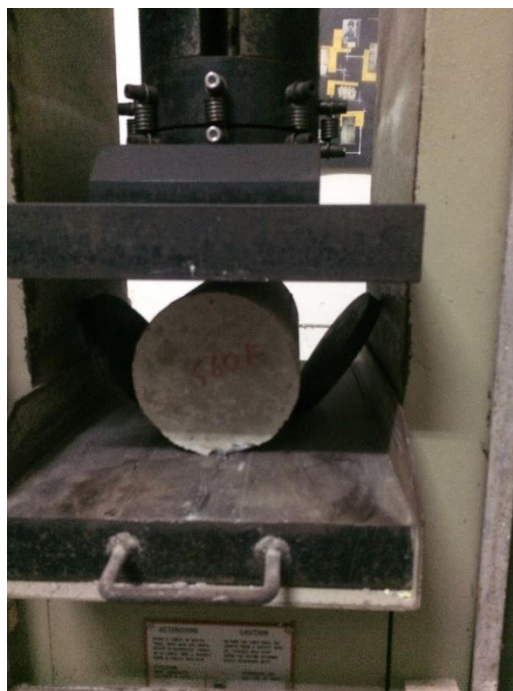
Gambar L3.3 Proses pengujian kuat tarik belah beton
