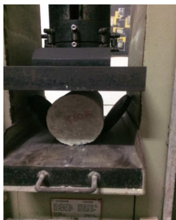
Gambar 4. 13 Perletakkan Benda Uji pada Pengujian Kuat Tarik Belah Beton
