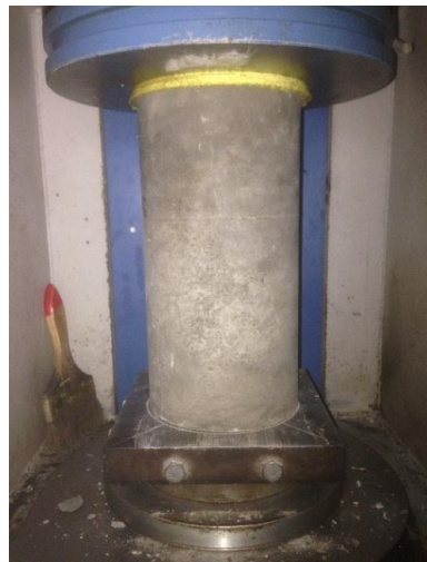
Gambar 4. 12 Perletakkan Benda Uji pada Pengujian Kuat Desak Beton
