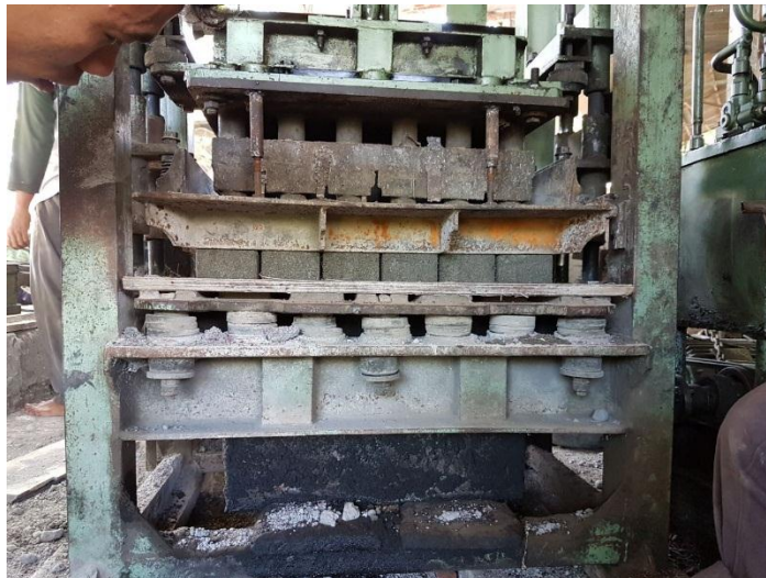
Gambar L-4.2 Proses Pencetakan Paving Block
