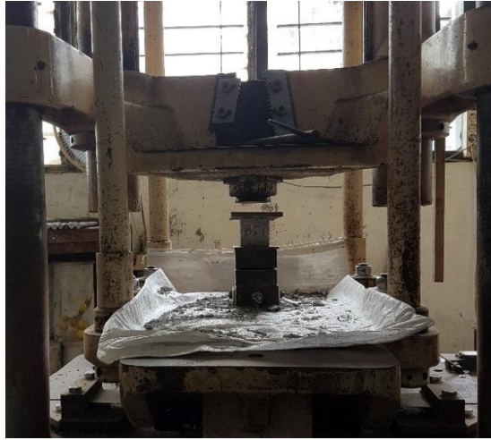
Gambar L-5.1 Pengujian Kuat Tekan Paving Block
