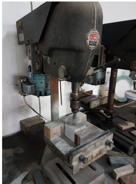
Gambar L-5.2 Pengujian Keausan Paving Block
