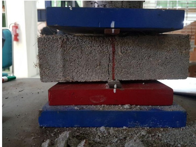
Gambar L-5.3 Pengujian Kuat Tarik Belah Paving Block
