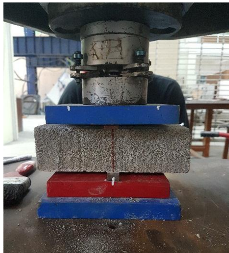
Gambar 5.8 Pengujian Kuat Tarik Belah
