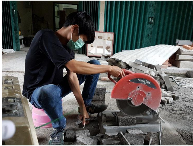
Gambar 4.5 Pemotongan Benda Uji
