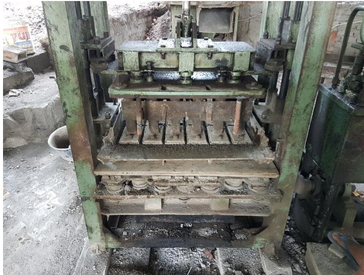
Gambar 4.4 Mesin Cetak Paving Block
