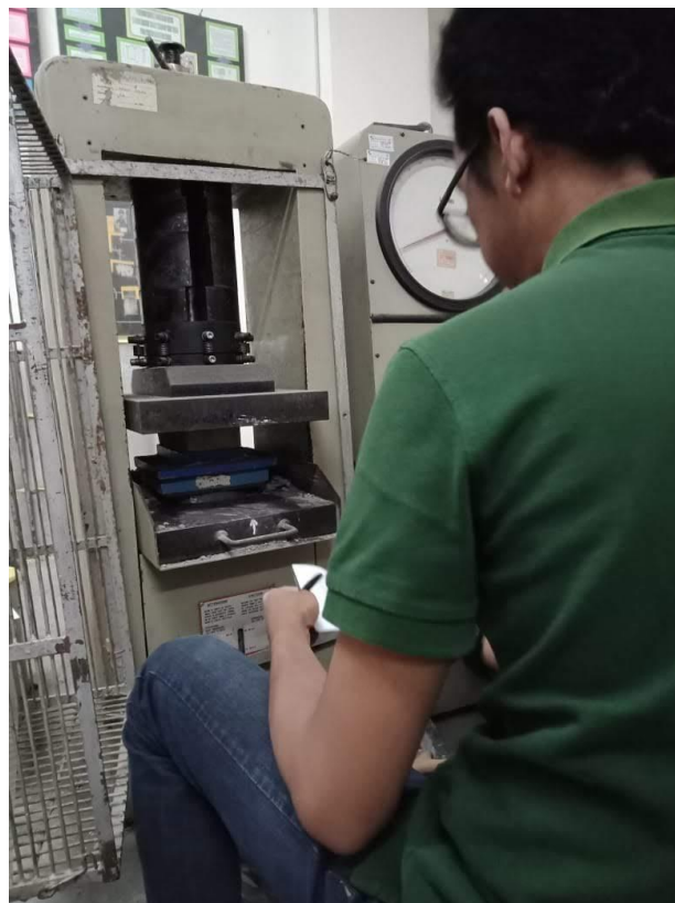
Gambar L-9.6 Pembacaan Beban Maksimum pada Pengujian Kuat Tekan
