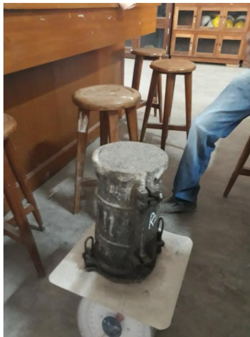
Gambar L-9.2 Silinder Berisi Pasir pada Pengujian Berat Volume Pada/Gembur Pasir
