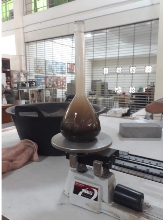
Gambar L-9.1 Pycnometer Berisi Pasir dan Air pada Pengujian Berat Jenis dan Penyerapan Air Pasir
