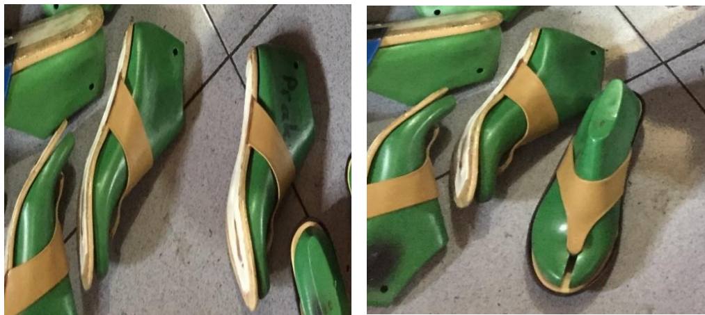
Gambar 4. 12 Proses pengeleman Sepatu
