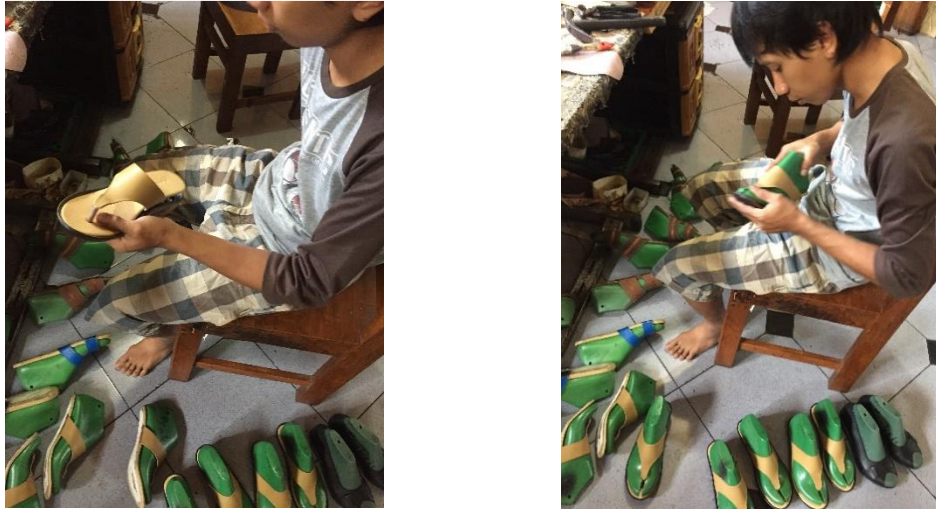
Gambar 4. 15 Proses Pengeleman Sol Sepatu dan Kap Sepatu
