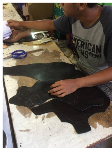
Gambar 4. 10 Proses Pembuatan Pola
