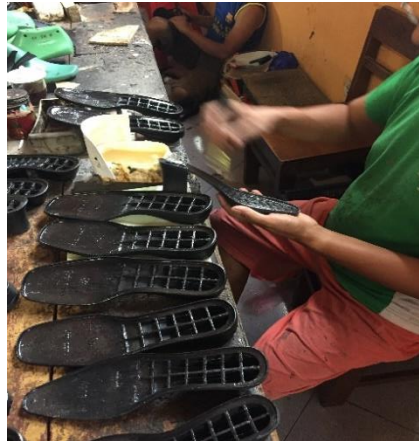
Gambar 4. 13 Proses Pengeleman Sol Sepatu
