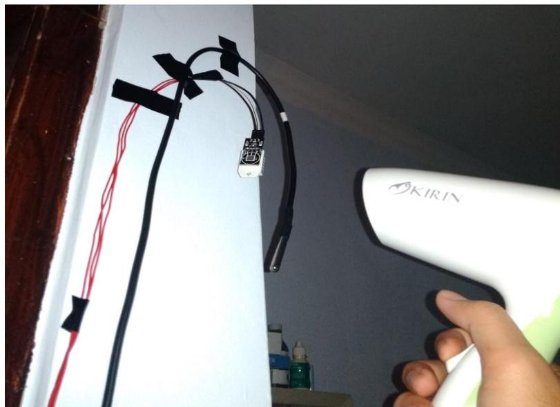
Gambar 4.4 Pemberian kondisi berupa panas udara menggunakan *Hairdryer*
