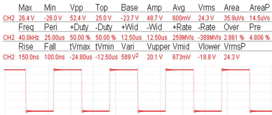
Gambar 4.7 Hasil *switching* 25 V<sub>DC</sub>
