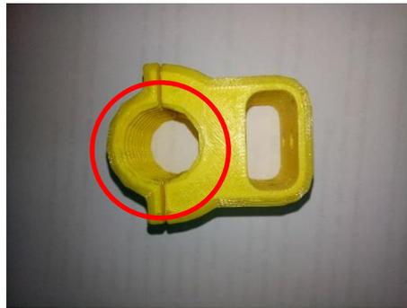
Gambar 4-72 Cacat pada penyambung
