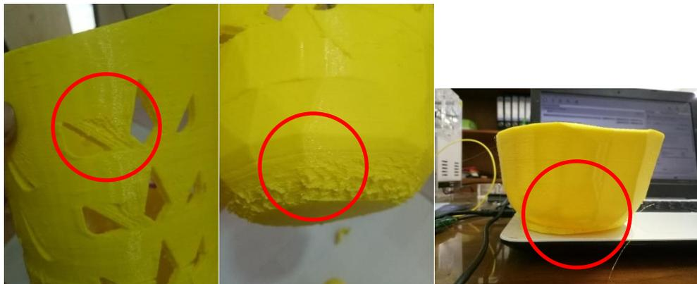
Gambar 4-73 Cacat pada *socket*
