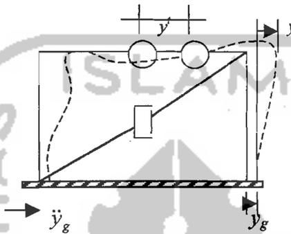
Gambar 3.3 Struktur SDOF dengan beban gempa
