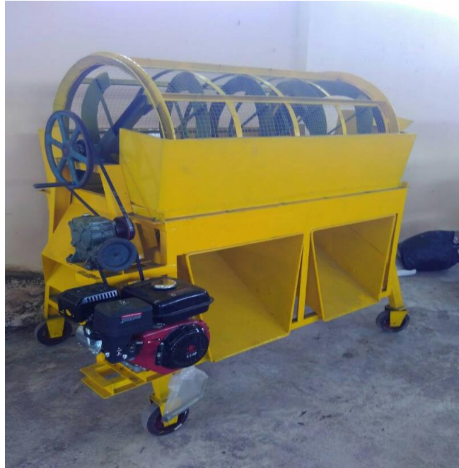
Gambar 1. Rancangan target mesin pengayak pupuk organik dari sampah domestik
