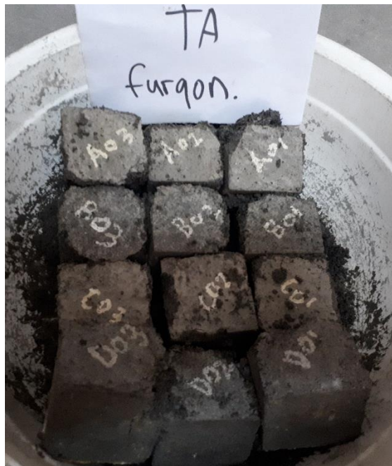
Gambar L-2.2 Hasil Pengujian Kuat Desak Mortar
