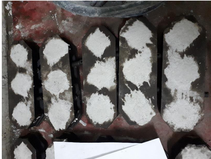
Gambar L-2. 1 Proses Pembuatan Benda Uji Mortar
